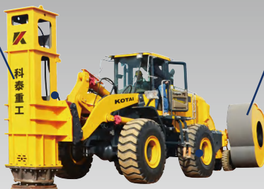
[RIC]HYDRAULIC RAPID IMPACT HAMMER 液压夯实机
